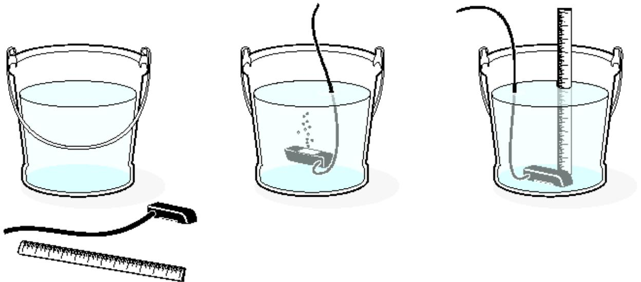
图23 漫没式面积/速度传感器校正
