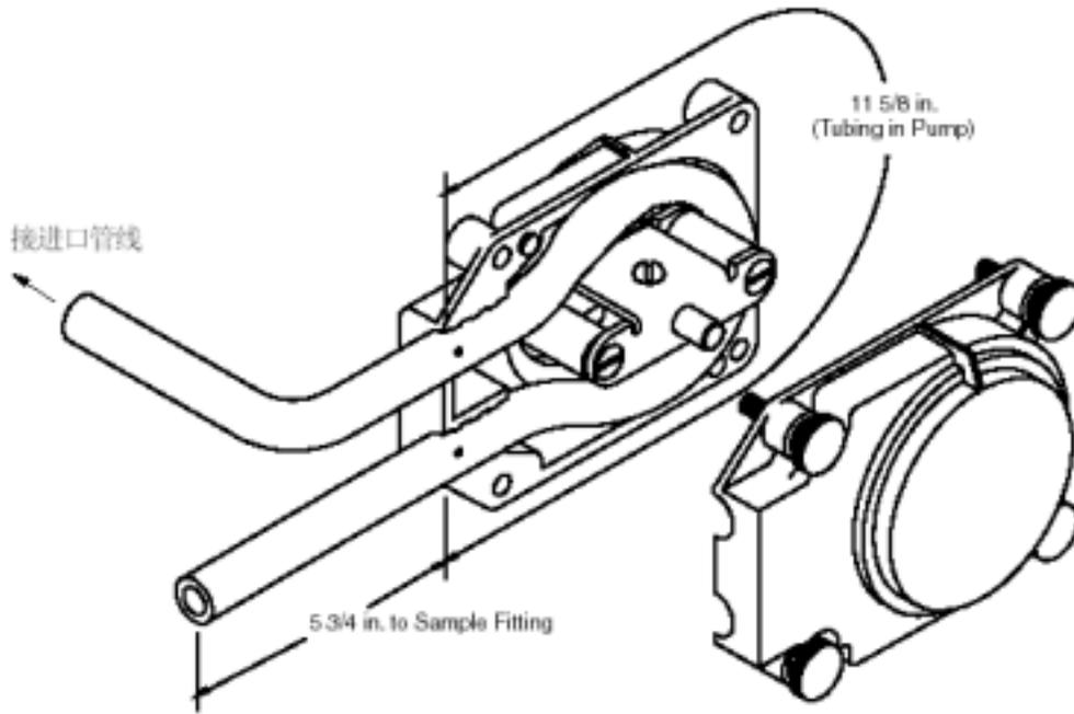
图7 泵管安装
