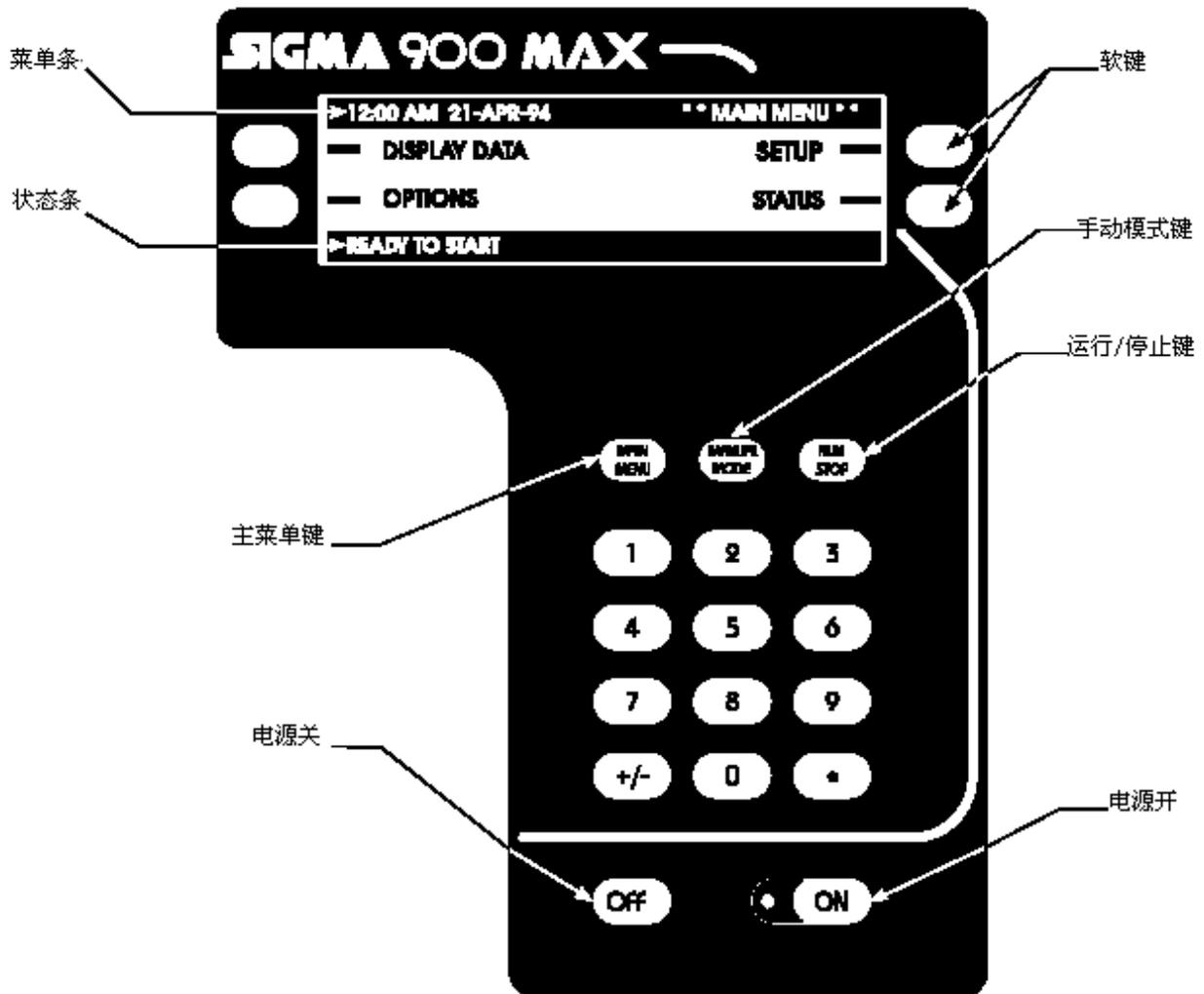
900MAX便携采样器前面板包括21个键、8行40字符液晶显示屏及内部湿度指示。
